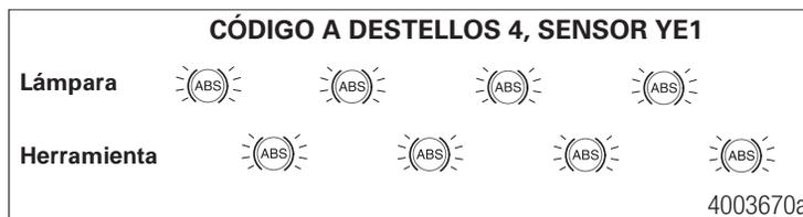
Aunque la ECU puede almacenar múltiples fallas de funcionamiento en su memoria, solo muestra una falla de funcionamiento a la vez. Por eso es importante volver a verificar los códigos a destellos después de reparar una falla de funcionamiento. Si hay otros códigos en la memoria, solo parpadearán después de que haya reparado la primera falla de funcionamiento.
